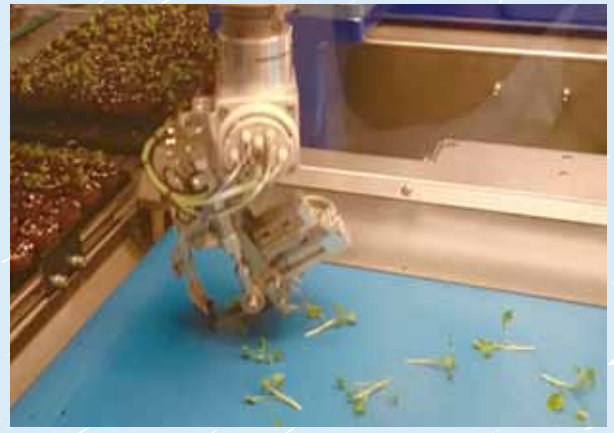
バラバラで流れ込んでくるカンパニュラの穂木を選抜し挿し木するロボット。（デンソー）
