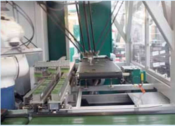
デンマークカクタスの挿し木ロボット：中央の黒いアームで苗の上下、サイズを選抜し左のデンソーのアームでプラグにさすロボットシステム。（デンソー）
